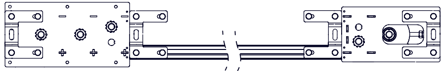
Abb. 5: Einbauvarianten – 1-läufiges Schienensystem mit Motor linksseitig und Umlenkeinheit rechtsseitig montiert
