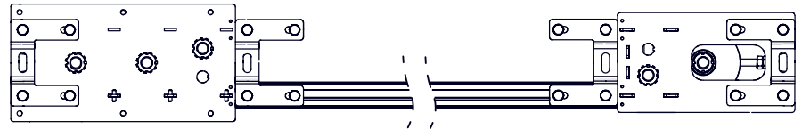
Abb. 5: Einbauvarianten – 1-läufiges Schienensystem mit Motor linksseitig und Umlenkeinheit rechtsseitig montiert
