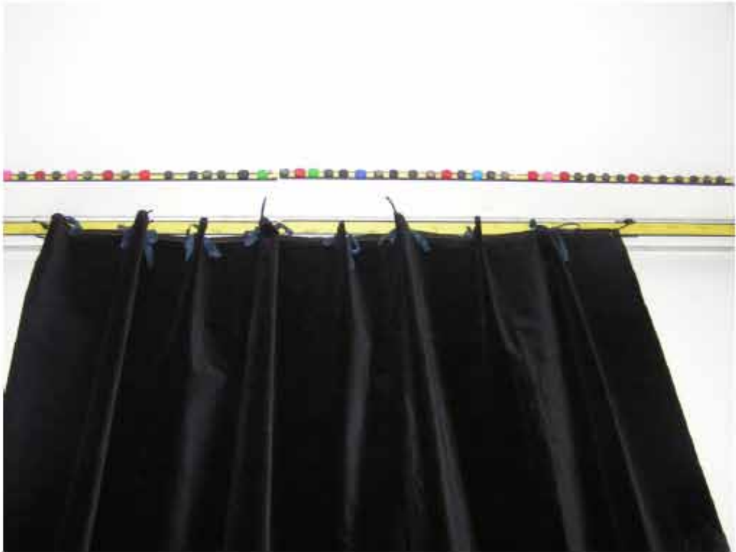
Foto B.3 Prüfaufbau mit 100 % Faltenzugabe im Hallraum
