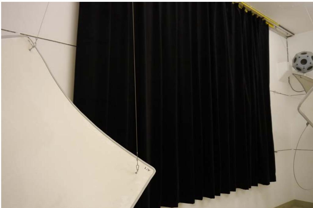
Abbildung B.2. Prüfaufbau im Hallraum – Vorhang mit Faltenzugabe (Aufbau 2).
