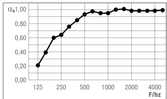
Schallabsorptionsgrad / Degré d'absorption acoustique / Acoustic absorption value =  $\alpha_w$
