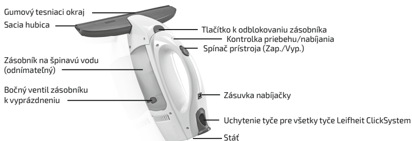
Obrázok 2: Obslužné prvky okenej odsávačky
