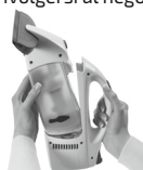
Figura 13: Montaggio del serbatoio
