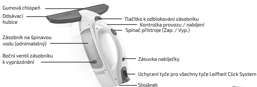
Obrázek 2: Obslužné prvky okenní odsávačky
